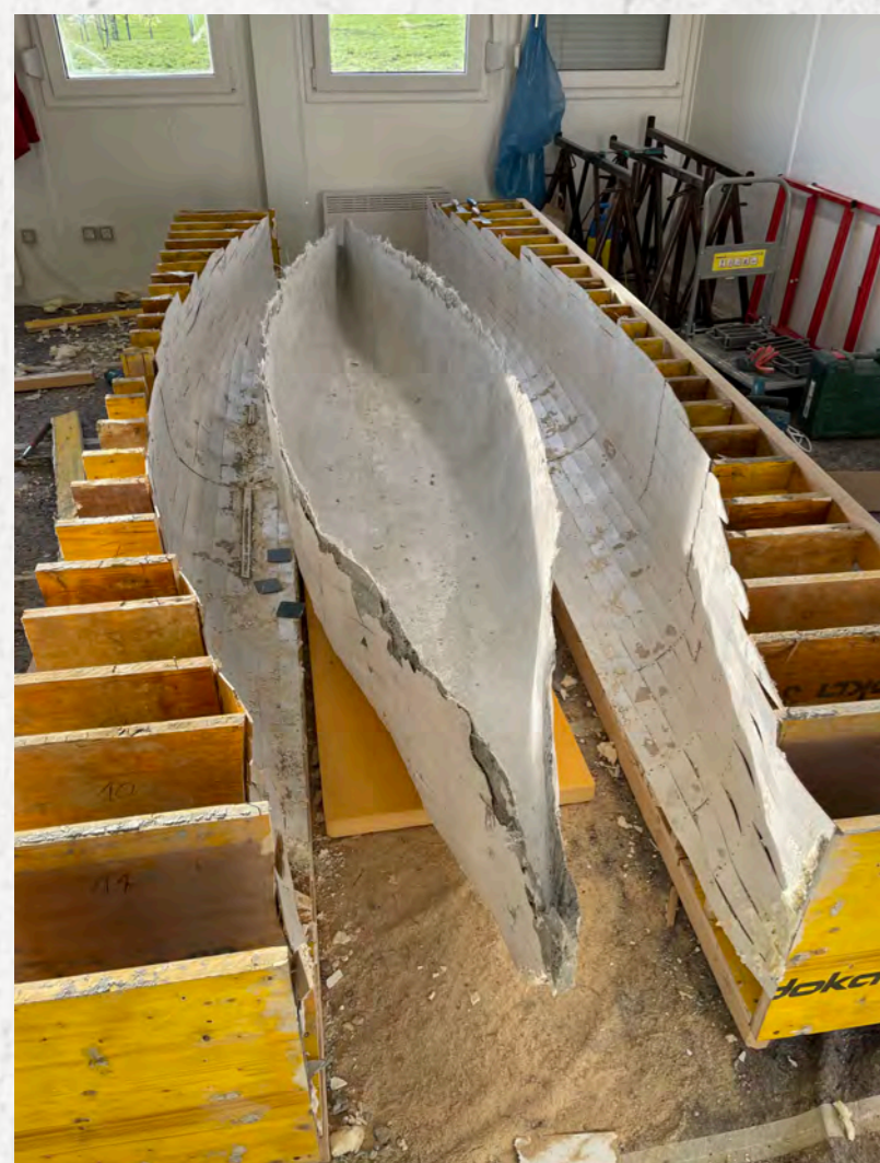
Ungeschliffen und frisch aus der Schalung
