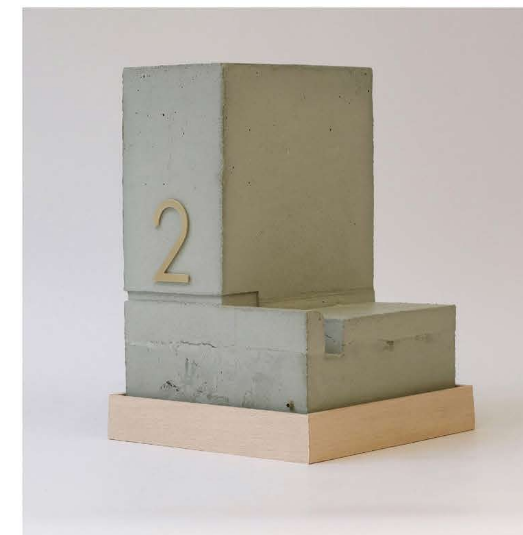
Außenwand mit integriertem Leitsystem
